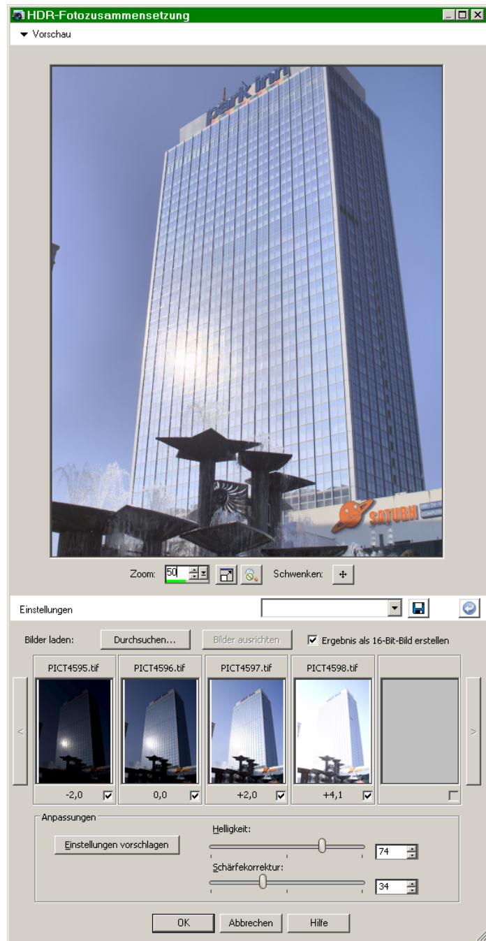
Abb. 9: Die HDR-Fotozusammensetzung kombiniert unterschiedlich belichtete Einzelphotos (die vier Miniaturen unten) zu einem einzigen Bild mit ausgewogenen Kontrasten.
